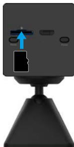
**i** Después de instalar la tarjeta Micro SD, debe activar la tarjeta en la aplicación EZVIZ antes de usarla.
