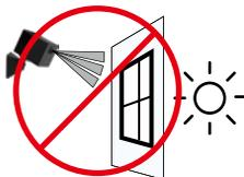
No instale la cámara bajo condiciones de luz intensa
